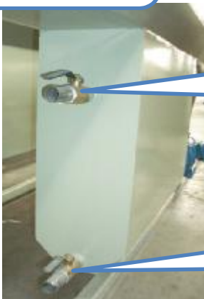
手动排水口 接管路通地沟 Manual drain
